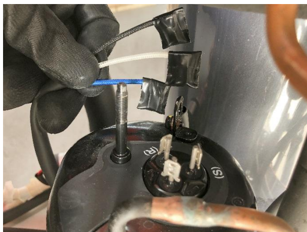
【使用电工胶布将接线端子不留触点完整包好】
