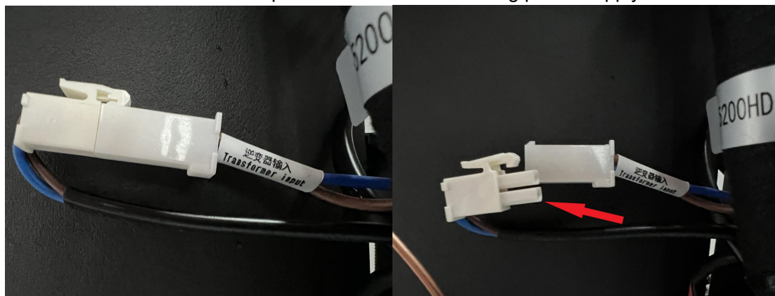
【左图：逆变器输入线束端子；右图：测量箭头所指位置内阻】
