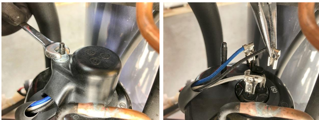
【左图：保护盖螺母松开示意图；右图：使用尖嘴钳将接线端子拔出】
