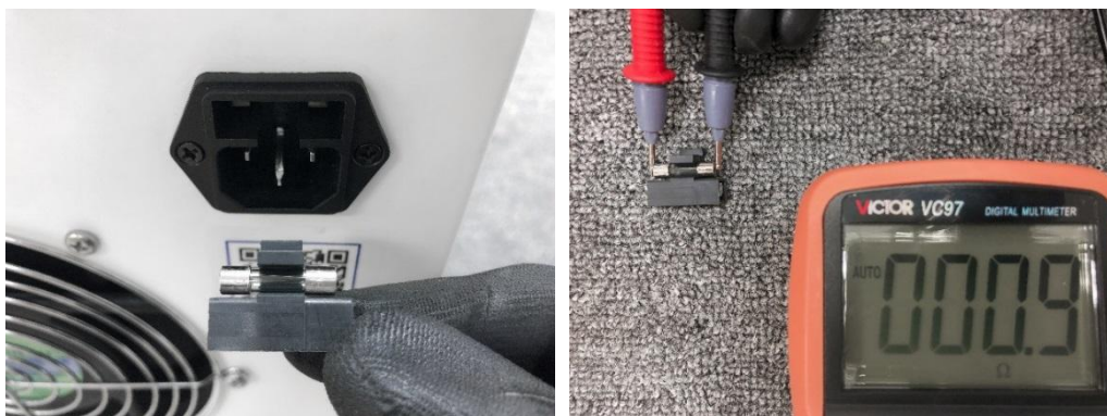
【左图：取出保险管座示意图；右图：测量保险管是否通路】
