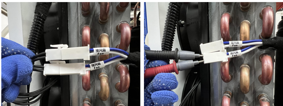
【左图：风扇线束端子（2个）；右图：测量内阻】
